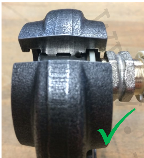
Správne usadenie čel'uste na lisovacom fittingu
