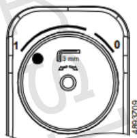
Ukazovateľ polohy na značke 1: Ventil otvorený
