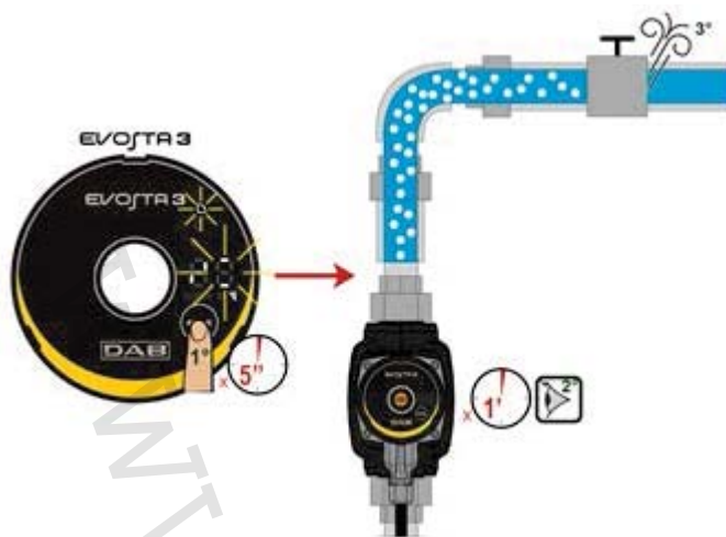
Obrázok 9: Automatické odvzdušnenie čerpadla
