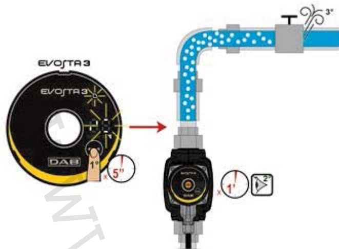
Obrázok 9: Automatické odvzdušnenie čerpadla
