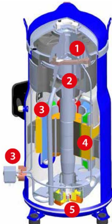
Obr. 2: Scroll kompresor Danfoss Performer VZH s invertorom 1/ Scroll 2/ Bezolovnaté polymérové ložiská 3/ Vstrekovanie oleja 4/ Motor s permanentnými magnetmi 5/ Olejový filter.
