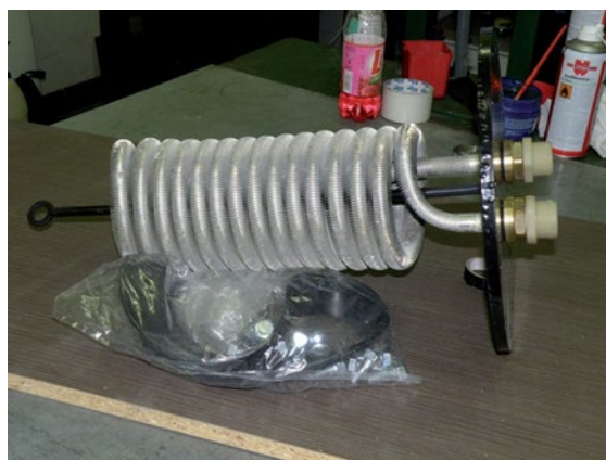
Izolačné oddelenie medenej vykurovacej vložky od prívodného a vratného potrubia
